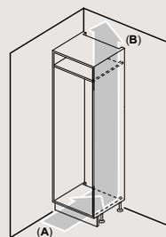
A: Belüftung  $\geq 200 \text{ cm}^2$ ; Belüftungsmöglichkeiten
