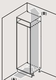
**A:** Belüftung ≥ 200 cm<sup>2</sup>; Belüftungsmöglichkeiten
