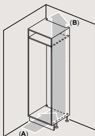
**A:** Belüftung ≥ 200 cm<sup>2</sup>; Belüftungsmöglichkeiten
