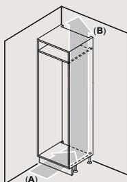
**A:** Belüftung ≥ 200 cm<sup>2</sup>; Belüftungsmöglichkeiten
